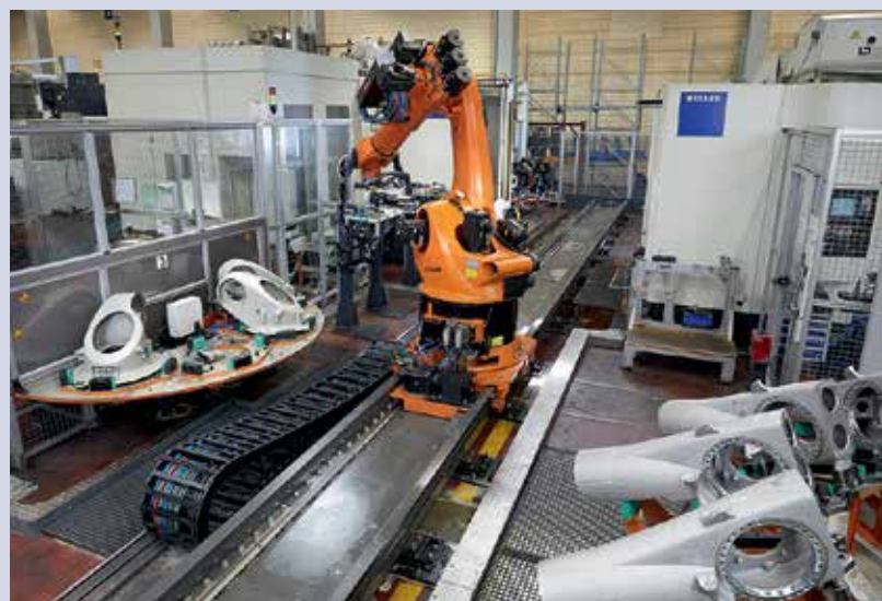
In einer digital vernetzten Anlage, bei der alle Komponenten in die Cloud eingebunden sind, produzieren zwei Bearbeitungszentren und ein Roboter Komponenten für Roboter.
